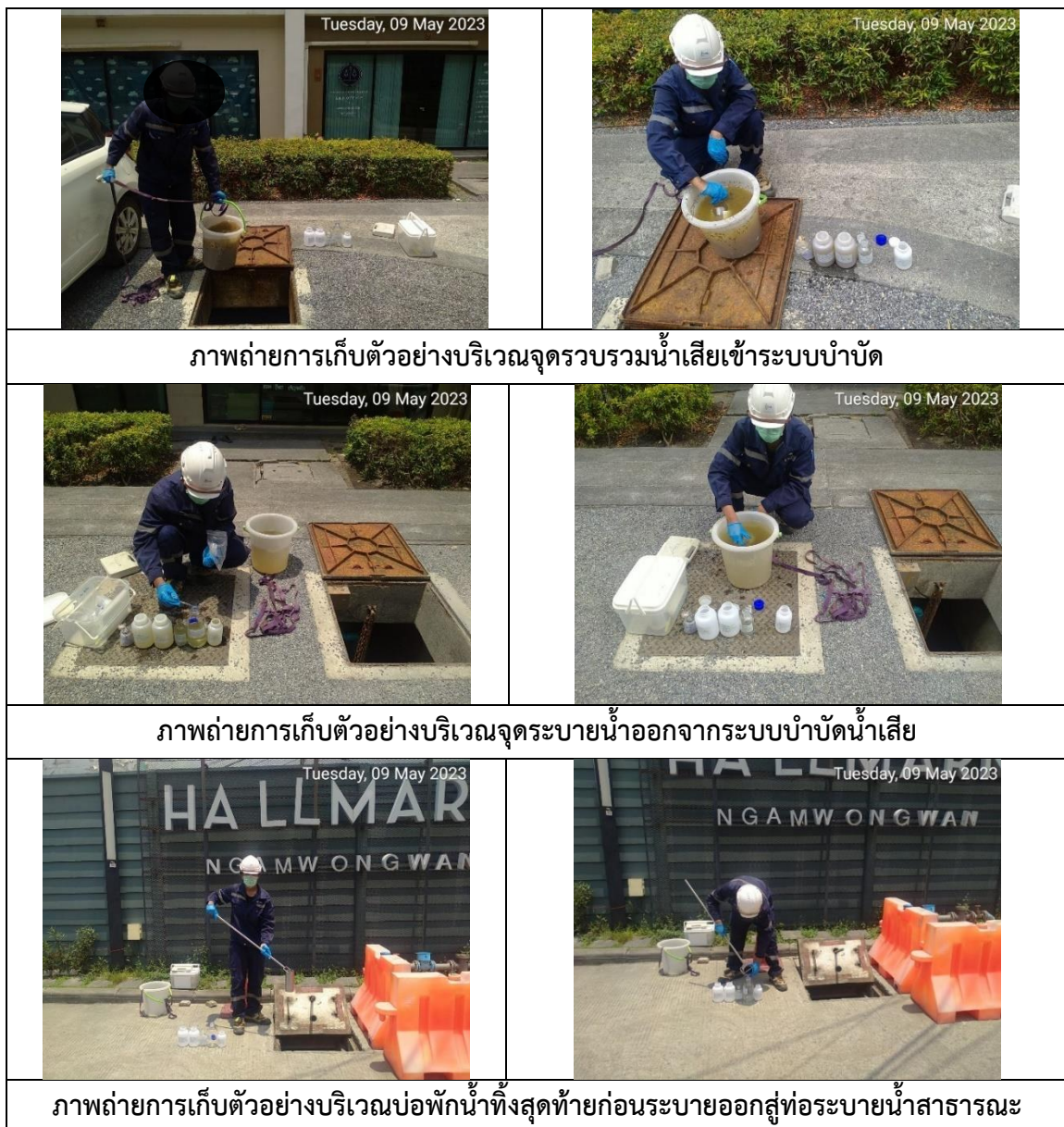
รูปที่ 3-3 ภาพถ่ายภาพการเก็บตัวอย่างคุณภาพน้ำจากระบบบำบัดน้ำเสีย
